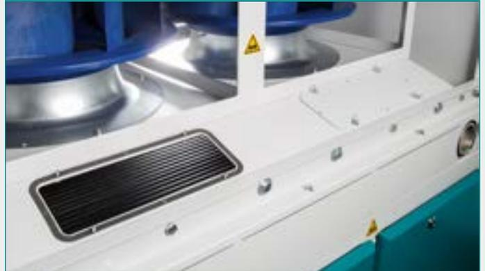
Der liegend verbaute Kühler kann über die Reinigungsklappen gereinigt werden. Alternativ kann der Kühler auch, wie eine Schublade zum Reinigen herausgezogen werden. Durch großzügig dimensionierte Öl- und Druckluftnackühler sowie die integrierte Öltemperaturregelung laufen die Anlagen auch bei hohen Umgebungstemperaturen einwandfrei.
