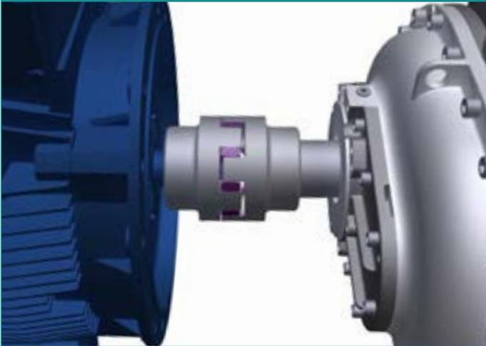
Der Direktantrieb verbindet den Verdichterblock 1:1 mit dem Antriebsmotor. Die nahezu verlustfreie Kraftübertragung garantiert zuverlässigen, leistungsstarken Betrieb des Kompressors. Die regelmäßig erforderliche Wartung reduziert sich auf das Nachschmieren des Motors. Alle Bauteile sind Markenprodukte führender Hersteller.
