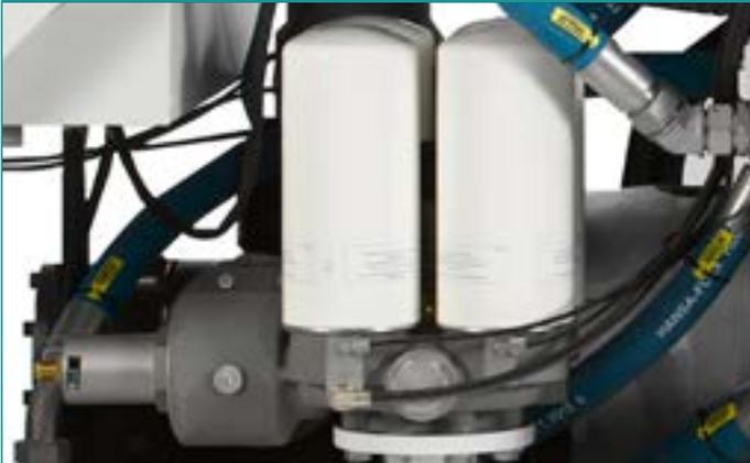
Kompressoren bis 127 kW sind mit drei beziehungsweise vier außenliegenden Abscheidern ausgestattet, welche im einfachen Spin-Off-/Spin-On-Verfahren gewechselt werden können. Durch den hervorragenden Abscheidegrad des gesamten Systems können die Kompressoren im Druckbereich von 5,0 bis 15,0 bar eingesetzt werden. Sonderdrücke auf Anfrage.
