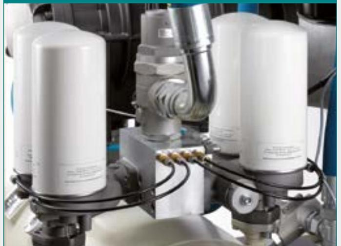
Die Kompressoren bis 160 kW sind mit außenliegenden Abscheidern ausgestattet, welche im einfachen Spin-Off-/Spin-On-Verfahren gewechselt werden können. Größere Anlagen besitzen eine innenliegende Abscheidepatrone. Durch den hervorragenden Abscheidegrad des gesamten Systems können die Kompressoren im Druckbereich von 5,0 bis 15,0 bar eingesetzt werden. Sonderdrücke auf Anfrage.
